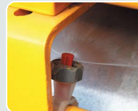
Система орошения вальца под давлением
