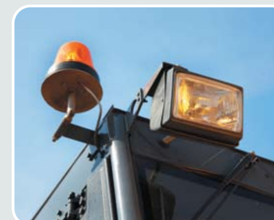
Рабочие фары и световая сигнализация
