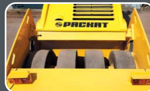
Пневмошины, вариант комбинированного катка
