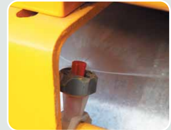
Система орошения вальца под давлением
