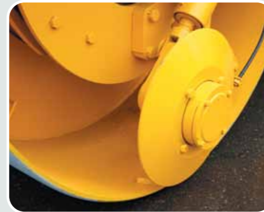
Устройство прикатки и обрезки кромки асфальтобетона
